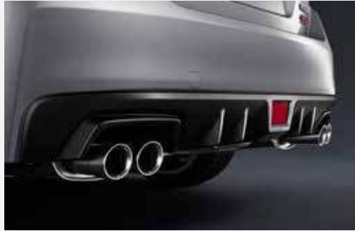
Tylny dyfuzor i tylny tłumik z dwoma podwójnymi wylotami spalin
