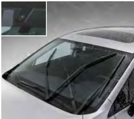
Wycieraczki z czujnikiem deszczu*1 Czujnik deszczu wykrywa obecność kropeł wody na przedniej szybie i reguluje odpowiednio prędkość pracy wycieraczek oraz przerwy wyłącznika czasowego.
