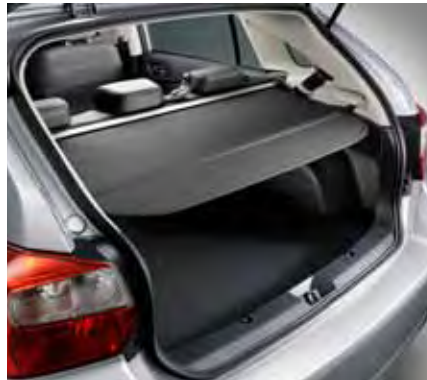
Demontowalna roleta bagażnika Roletę bagażnika można zwinąć lub wyjąć. Wyposażono ją w sztywną, aluminiową ramę.
