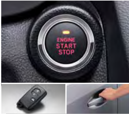
Dostęp bez kluczyka, rozruch przy użyciu przycisku*1 Odblokuj przednie drzwi lub pokrywę bagażnika, włącz silnik i jedź - a wszystko to bez wyjmowania kluczyka z kieszeni!
