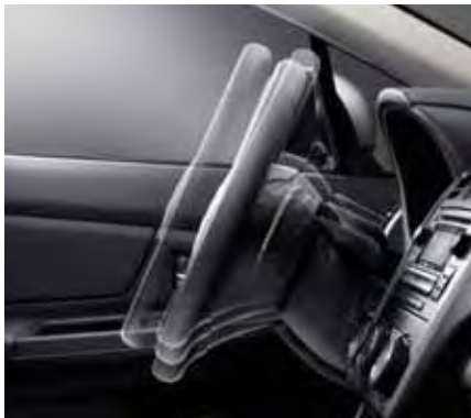
Kolumna kierownicza regulowana w dwóch płaszczyznach. Regulowana w dwóch płaszczyznach kolumna kierownicy (góra - dół i teleskopowo) pomaga w ustaleniu jak najlepszej pozycji podczas prowadzenia samochodu.
