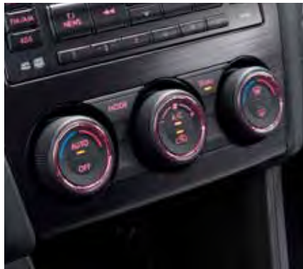
Dwustrefowa klimatyzacja automatyczna*1 Temperaturę powietrza przepływającego po stronie kierowcy i pasażera można, dzięki dwustrefowej klimatyzacji, regulować oddzielnie. Filtr przeciwpyłkowy zapobiega przedostawaniu się kurzu do kabiny.
