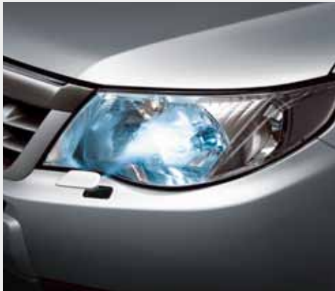
Reflektory ksenonowe* i wysuwane spryskiwacze reflektorów Opcjonalne reflektory ksenonowe dostarczają jaśniejszego, bardziej białego oświetlenia drogi. Spryskiwacze czynią je bardziej efektywnymi podczas złej pogody.
