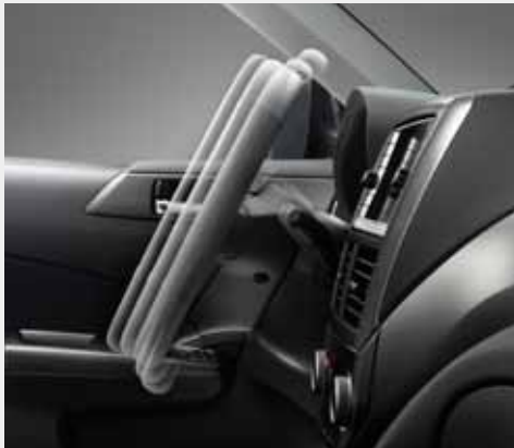
Regulacja położenia kolumny kierownicy w dwóch płaszczyznach Aby przyjąć optymalną pozycję za kierownicą, można ustawić jej wysokość ruchami góra - dół a także odległość od siedzenia, regulując długość kolumny kierowniczej.
