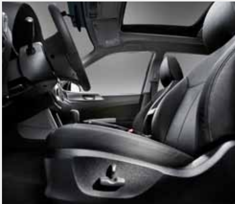
Elektryczna regulacja fotela kierowcy* Siedzenia ze skórzanym poszyciem wyposażone są w elektryczną regulację ustawienia fotela kierowcy (w 8 kierunkach).
