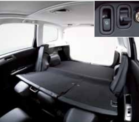
Oparcia tylnych foteli składane przy użyciu jednego przycisku* Naciśnięcie jednego z przycisków umieszczonych w bagażniku powoduje automatyczne złożenie dzielonych w stosunku 60:40 oparc. Pozwala to na wyjątkowo łatwe powiększenie przestrzeni bagażowej.
