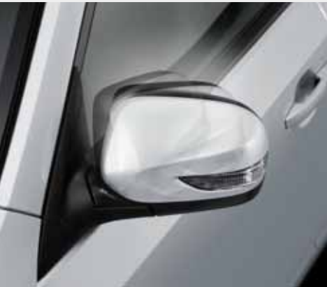
Elektrycznie składane lusterka zewnętrzne* Elektrycznie regulowane i ogrzewane lusterka zewnętrzne o niskim oporze aerodynamicznym, zawierają diodowe lampy kierunkowskazów. Funkcja elektrycznego składania ułatwia parkowanie w ciasnych miejscach.
