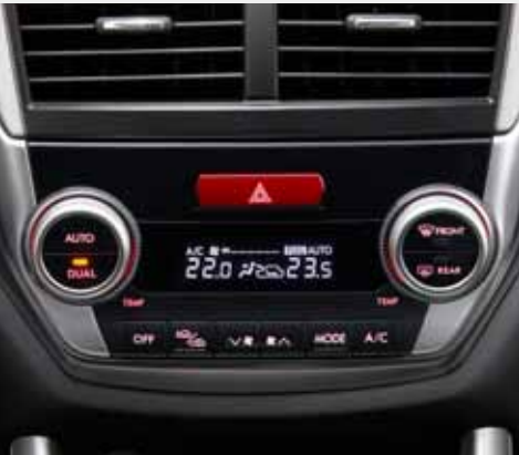
Dwustrefowa, automatyczna klimatyzacja* Panel sterowania klimatyzacją wyposażono w eleganckie, podświetlane wskaźniki oraz w cyfrowy wyświetlacz. Dla poprawienia komfortu, temperaturę ustawia się oddzielnie dla kierowcy i dla pasażera z przodu.
