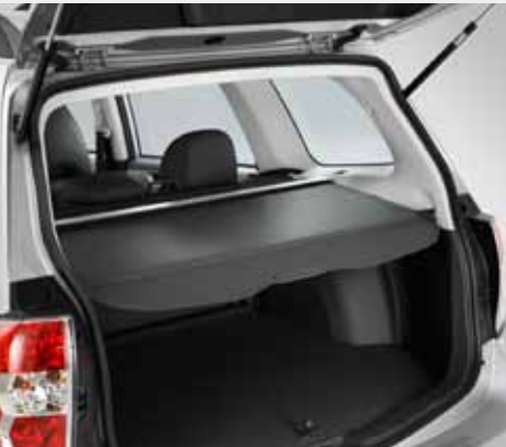
Demontowalna roleta bagażnika Roletę można złożyć lub wyjąć. Wyposażono ją w sztywną, aluminiową ramę.
